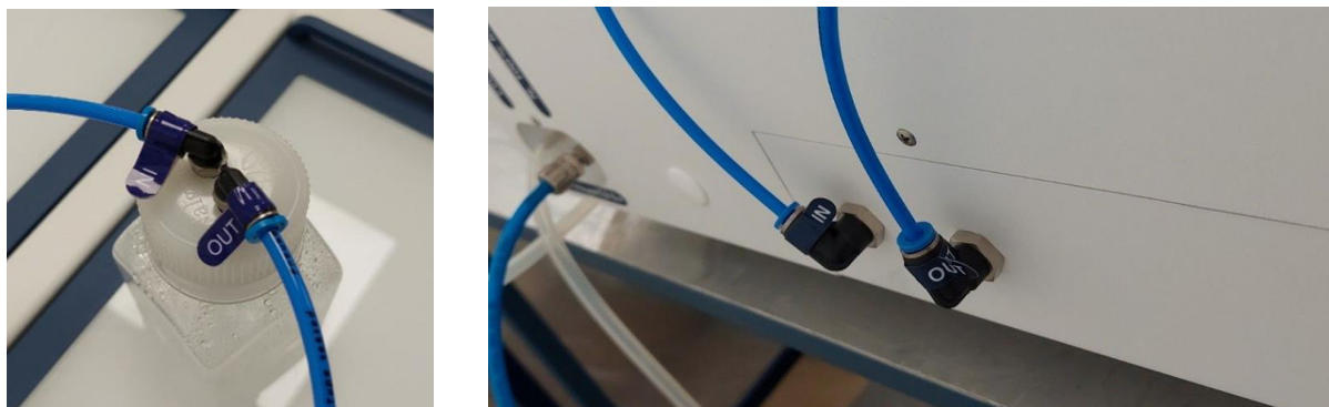
Obrázok 23.1 Pripojenie trubice na zvlhčovacej fľaši a multikomorovom zariadení MIRI® Humidity IVF inkubátora
